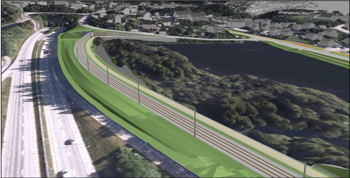
Figur 7-11: Oversiktsperspektiv av E39 i øst og Bybanen i vest over Stemhøyen, sett fra nord. Viser inngrepet banen gir i grøntarealene mellom E39 og Griggastemma.
