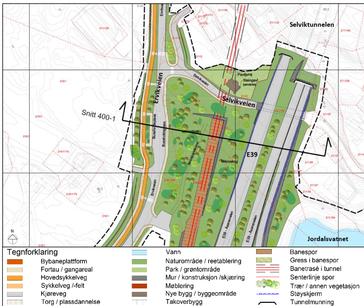
Figur 6-23: Utsnitt av illustrasjonsplan, område der bybanen foreslås lavt i terrenget med etablering av mikroskog på begge sider for å opprettholde eksisterende grønt preg. Svart stiplet linje er planens avgrensning.
