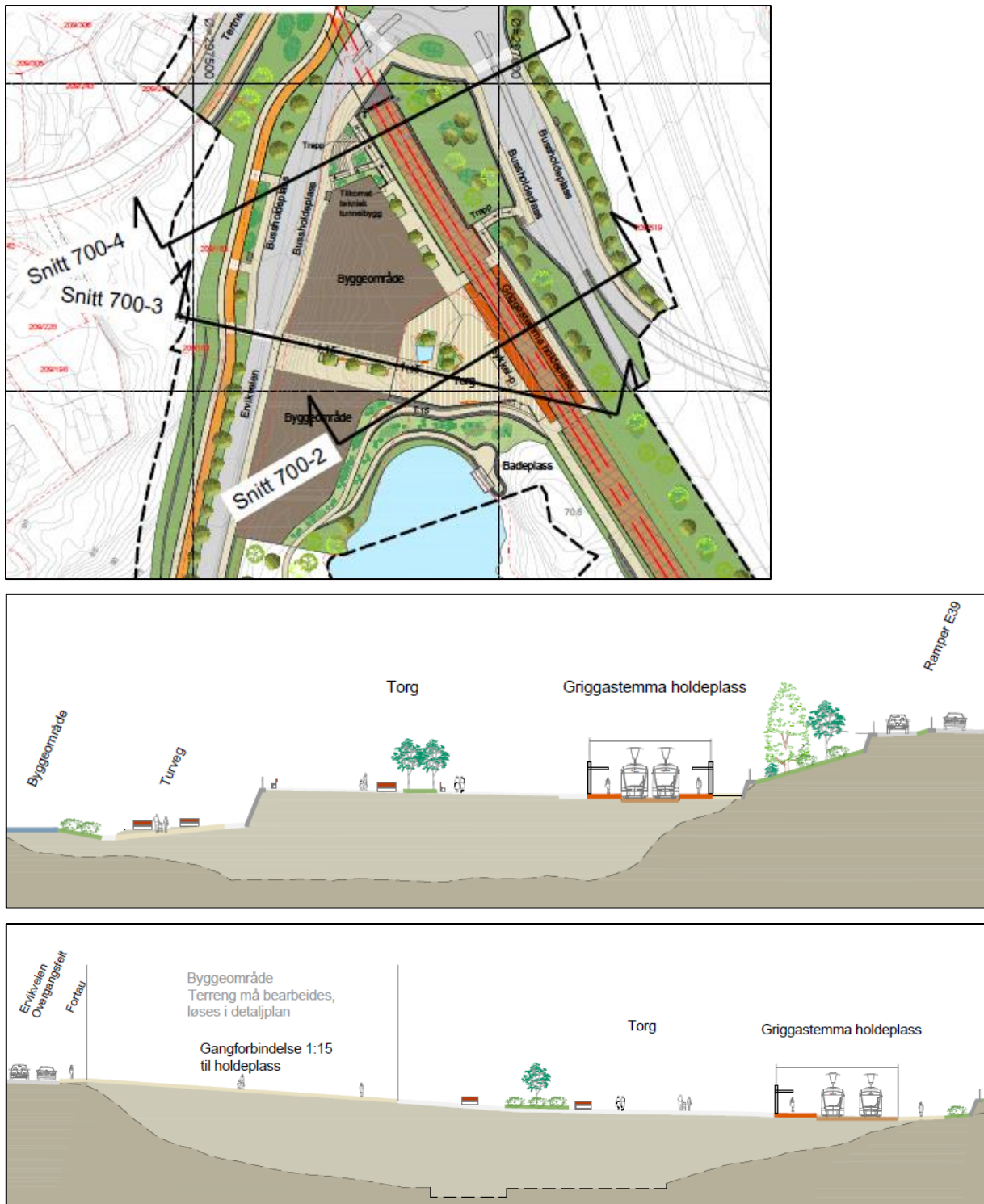
Figur 6-33: Snittegning og utsnitt av snitt 700-2 øverst og snitt 700-3 nederst. Viser hvordan området fylles opp for å kunne etablere bybaneholdeplass med tilhørende torg og gatetun.
