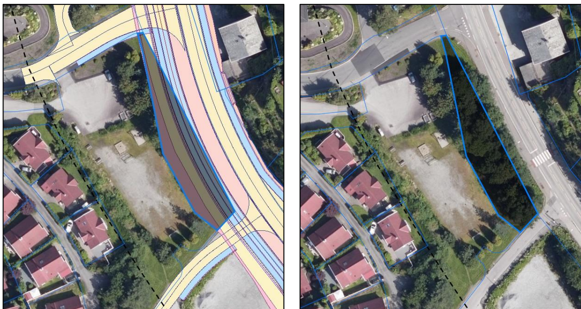
Figur 7-27: Blå linje er areal som beslaglegges til nytt vegsystem m/ hovedsykkelrute og tilhørende bekkeløp
